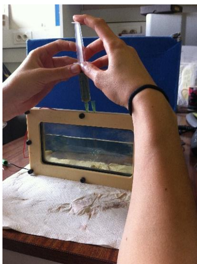
Figure 11 et 12 : insertion de l'électrolyte entre les deux plaques.
