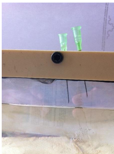
Figure 11 et 12 : insertion de l'électrolyte entre les deux plaques.
